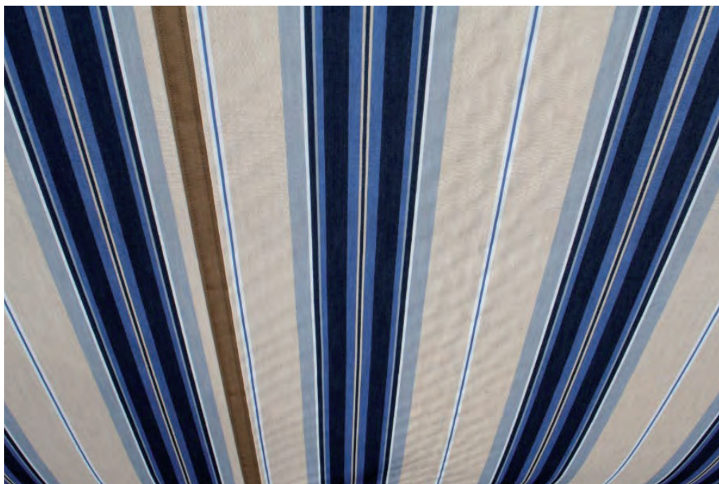
Bild 9.1.10 Zulässige Welligkeit im Bahnbereich (Wabenbildung)
